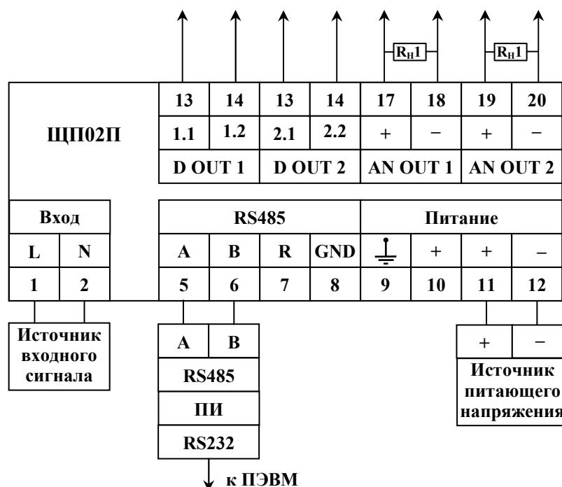
a) для исполнений с параметром  $c = 5\text{ВН}, 12\text{ВН}, 24\text{ВН}$
