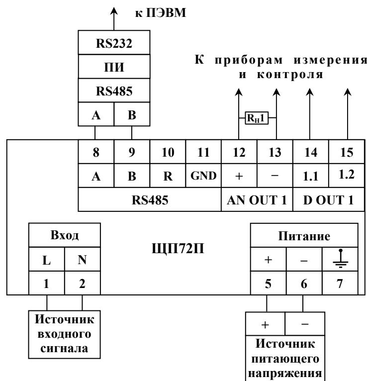
а) для исполнений с параметром  $c = 5\text{ВН}, 12\text{ВН}, 24\text{ВН}$
