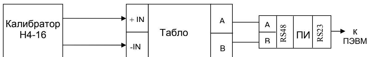
Рисунок 2 – Схема проверки табло с входным сигналом силы тока или напряжения
