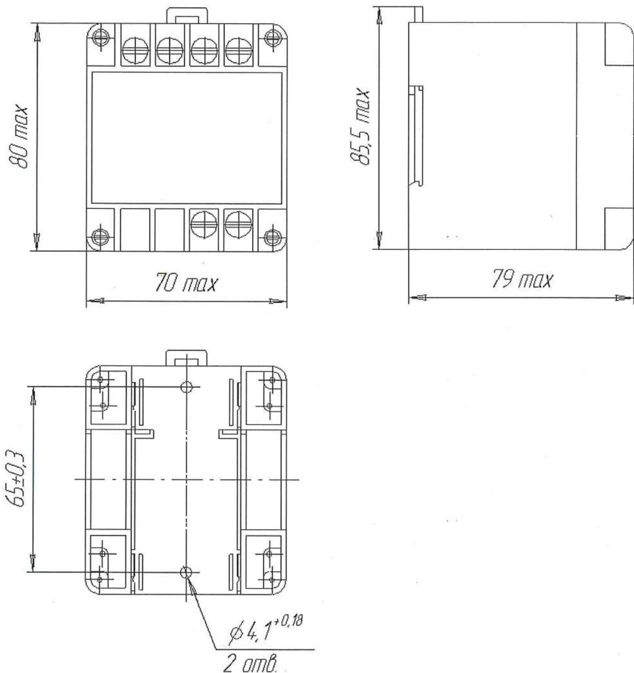
Рисунок А.2 – Габаритные и установочные размеры преобразователя Е854ЭЛ, не имеющего исполнение с интерфейсами и изготовленного до 08.2023 г
