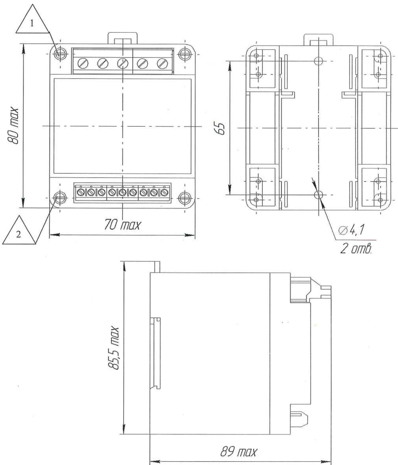
Рисунок А.1 – Габаритные и установочные размеры преобразователя Е854ЭЛ
