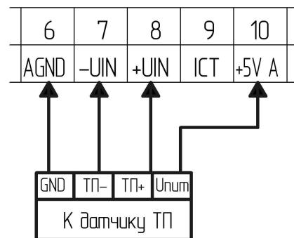
Рисунок В.3 – Схема подключения указателей ЩУП96, ЩУП120
