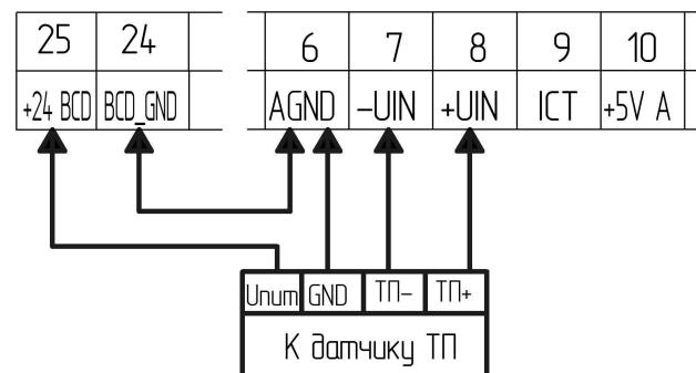
Рисунок В.3 – Схема подключения указателей ЩУП96, ЩУП120
