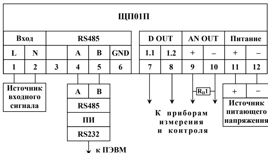
Рисунок Б.2 – Схема подключения приборов
