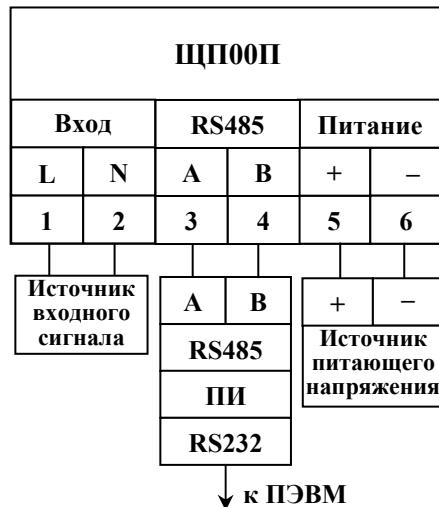
Рисунок Б.1 – Схема подключения приборов
