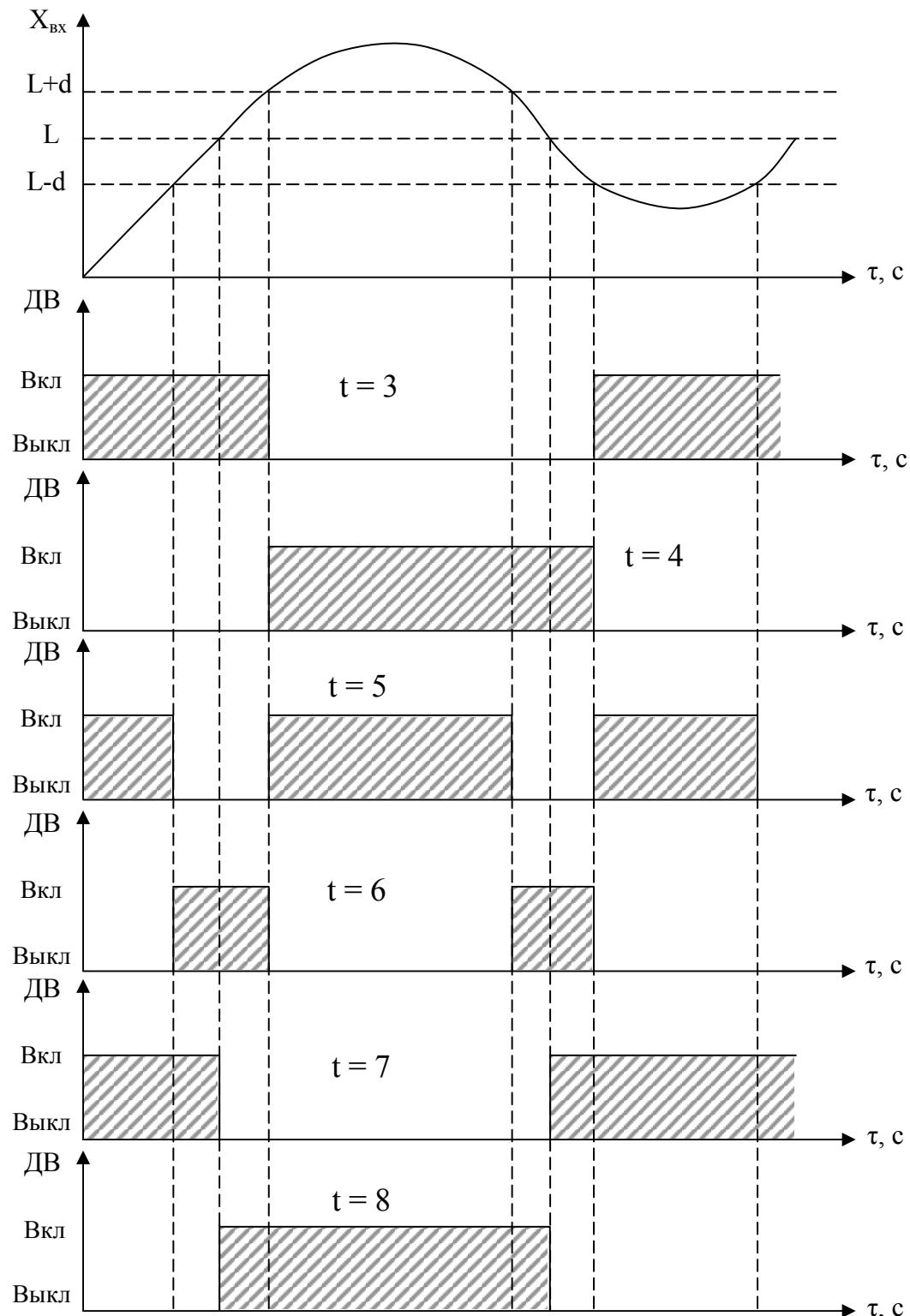
Рисунок Е.1 – Логика работы дискретных выходов при  $t = 3, 4, 5, 6, 7, 8$
