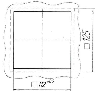
Рисунок А.1 – Габаритные размеры ваттметра
