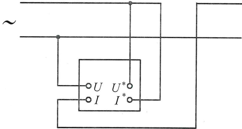
Рисунок Б.1 – Непосредственное включение ваттметра в сеть
