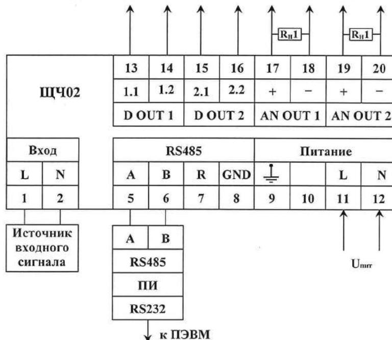
$U_{пит}$  – напряжение питания от 85 до 264 В переменного тока частотой 50 Гц или от 120 до 370 В постоянного тока (220ВУ), напряжение питания от 85 до 264 В переменного тока частотой 50 Гц (230В).
