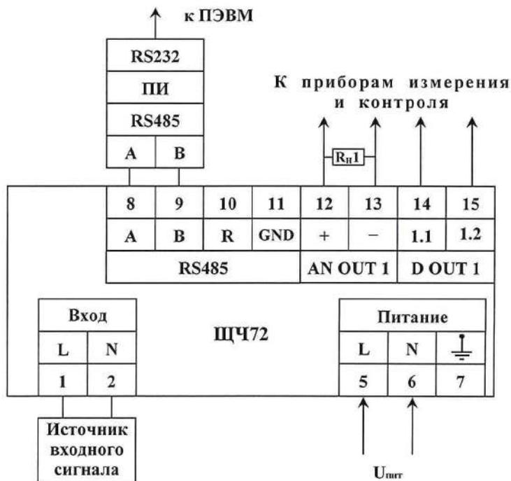
$U_{пит}$  – напряжение питания от 85 до 264 В переменного тока частотой 50 Гц или от 120 до 370 В постоянного тока (220ВУ), напряжение питания от 85 до 253 В переменного тока частотой 50 Гц (230В).
