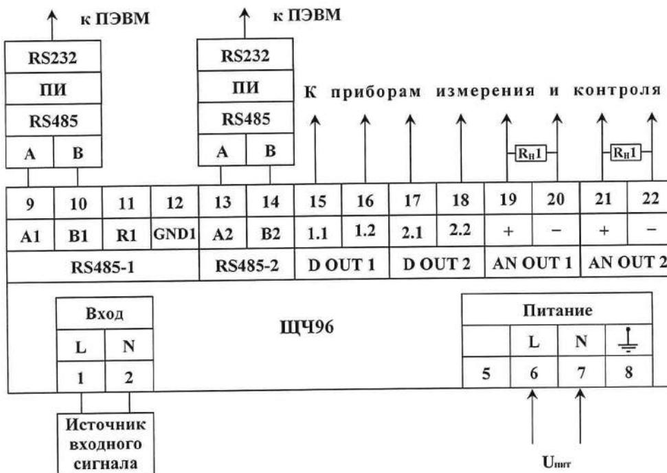
U<sub>пит</sub> – напряжение питания от 85 до 264 В переменного тока частотой 50 Гц или от 120 до 370 В постоянного тока (220ВУ), напряжение питания от 85 до 264 В переменного тока частотой 50 Гц (230В).
