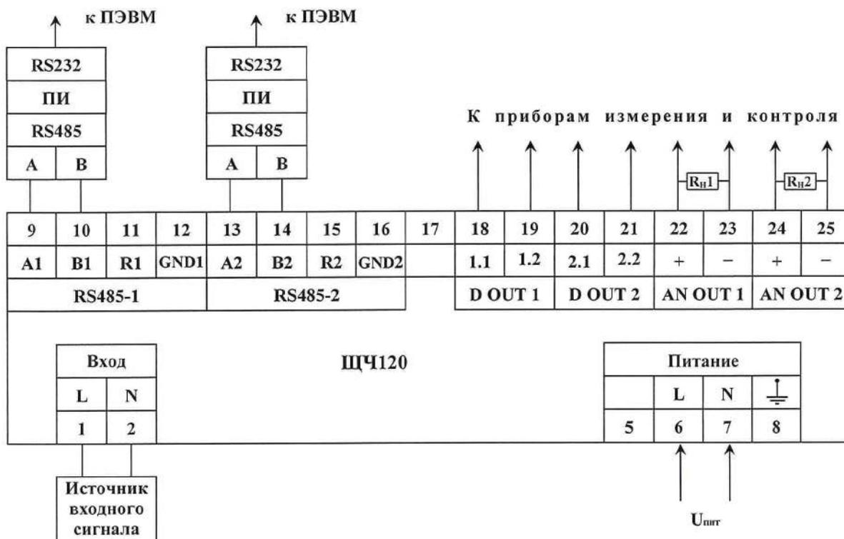
$U_{пит}$  – напряжение питания от 85 до 264 В переменного тока частотой 50 Гц или от 120 до 370 В постоянного тока (220ВУ), напряжение питания от 85 до 264 В переменного тока частотой 50 Гц (230В).
